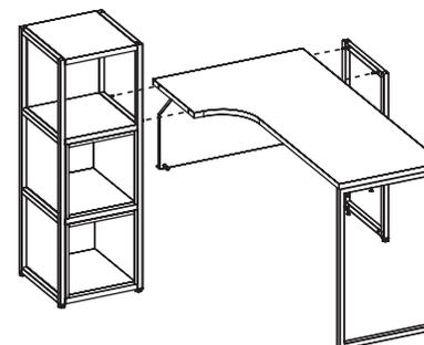
Parafuse o Pé Metálico no tampo e fixe o conjunto de tampo nas estruturas metálicas (módulos) da linha Make.
